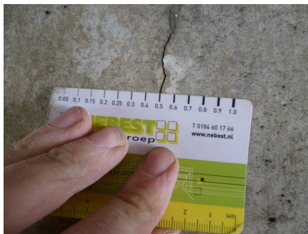
Figuur 4.17: Scheurwijdte 0,5 mm STP03
